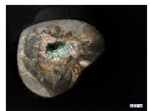
Hier musste die Produktion unterbrochen werden, da Kern gerissen. Kühlwasser dringt in Formnest ein.
