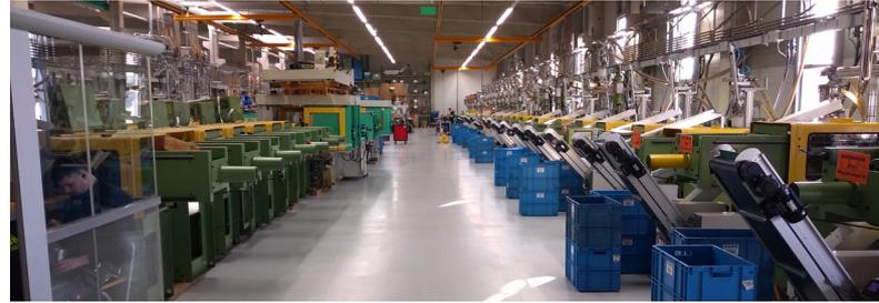
Die Maschinen überhitzen bei Temperaturen über 50°, dadurch mussten tagsüber vermehrt Maschinen abgeschaltet werden. Als Konsequenz baute man zunächst alle nicht notwendigen Ventile aus, um das Wasser mit voller Geschwindigkeit zirkulieren zu lassen. Doch dann bildete sich an kühleren Sommertagen häufig Kondenswasser, was z.B. für Schaltschänke ein großes Risiko birgt und vermieden werden muss.
